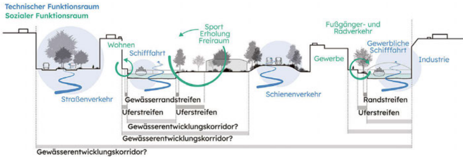
Abbildung 2: Räumliche Aufteilung sozialer und technischer Funktionen im urbanen Gewässerentwicklungskorridor. Quelle: Katarina Bajc, Florian Carius.
