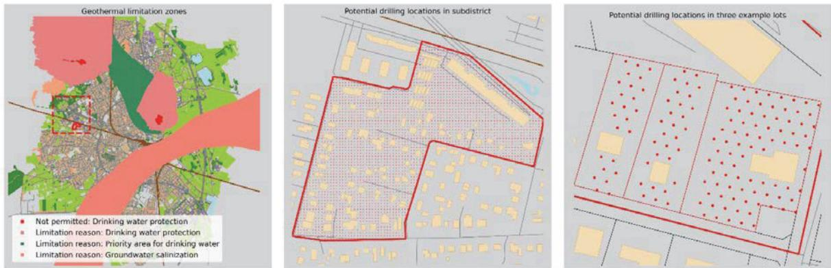
Abb. 3: Beispielhafter Datenworkflow für die Abschätzung des Geothermiekpotentials: Restriktionszonen (links) in einem Quartier (Mitte), und auf Grundstücksebene unter der Berücksichtigung von Abstandsregeln (rechts).
