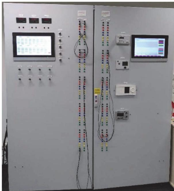
Fig. 1 Teststand für Heizungsregler am Technologiezentrum Energie-Campus
