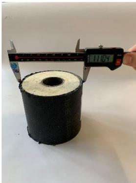
Abb. 44: PE-Durchmesser
