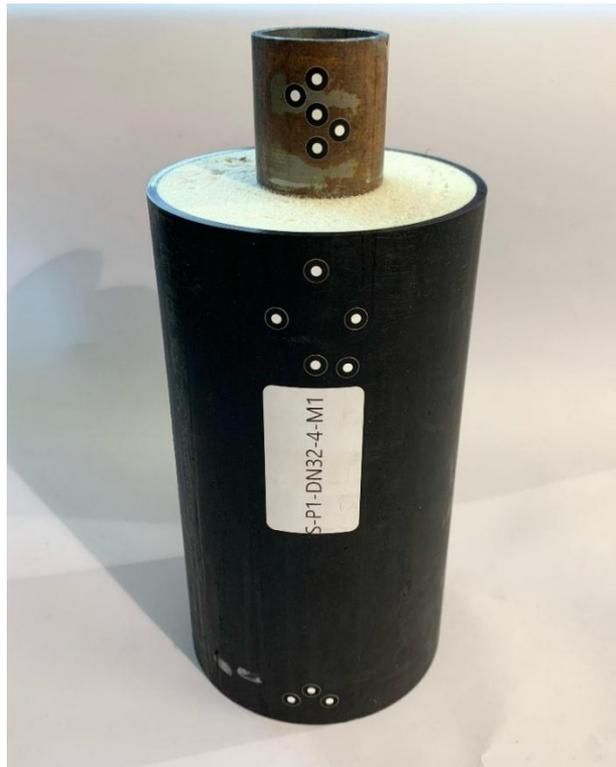
*Abb. 60: Probekörper mit Messmarken zur Scherfestigkeitsprüfung [Eigene Darstellung]*
