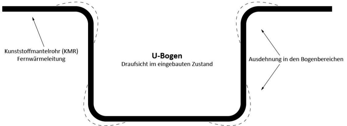
Abb. 12: Kompensation temperaturinduzierter Längenänderungen im U-Bogen [Eigene Darstellung]
