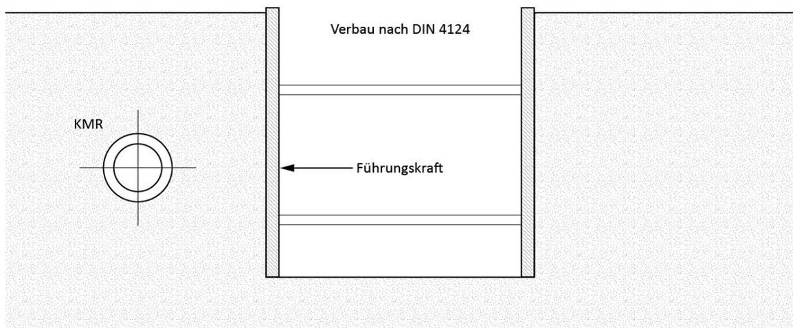
Abb. 9: Baugrube neben KMR mit Verbau nach DIN 4124 [Eigene Darstellung]
