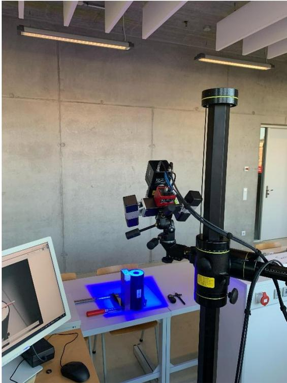
Abb. 48: Aufbau Koaxialitätsmessung [Eigene Darstellung]
