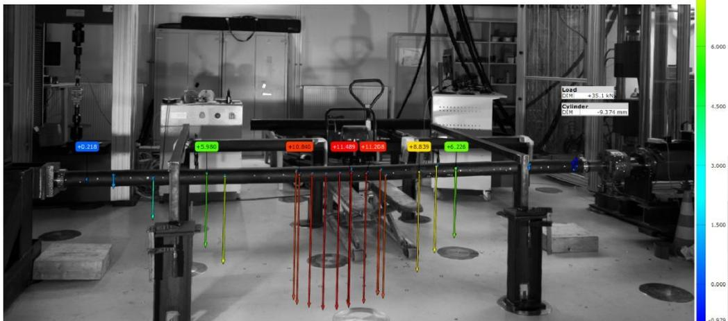
Abb. 15: Biegeknickversuch des S-P1-DN32-4 [Eigene Darstellung]
