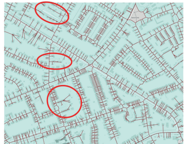
Abb. 7: Im Workflow erzeugte Anschlussleitungen einzelner Wärmeabnehmer zu den fiktiven Hauptleitungen des Wärmenetzes (Baublock-Außengrenzen)
