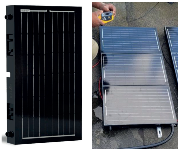
Abbildung 7: PVT-Modul 2, Einzelansicht (links) und 3 Module angeschlossen (rechts)
