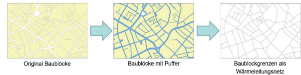
Abb. 3: Von Baublöcken (Polygonen) über Puffer und Entfernen von Überschneidungen zu einem fiktiven Wärmeleitungsnetz (Polylinien)
