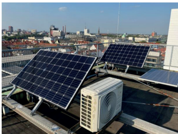
Abbildung 5: PVT-Prüfstand der Hochschule Bremen mit dem PVT-Modul 1
