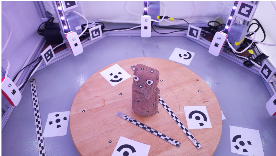
Abbildung 7.3.: Drehteller mit Moai-Figur im Prototypen (aufgenommen von einem der verbauten Raspberry Camera Module 3)
