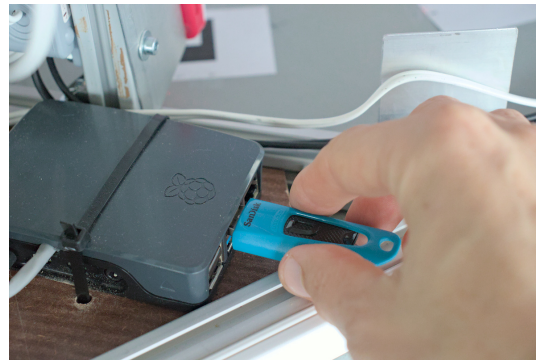
(b) Anschluss eines USB-Sticks zur Datenübertragung
