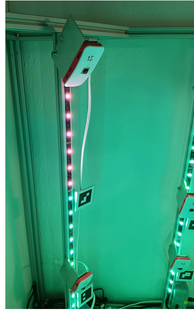
(b) Farbige Beleuchtung zur Statusmeldung
