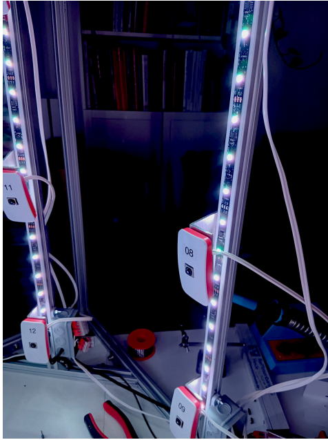
(a) Schattenarme Beleuchtung durch LED-Streifen
