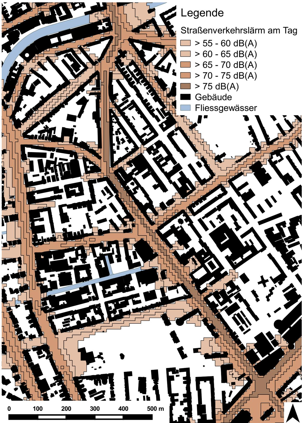
Abb. 19: Lärmemissionen am Tag, Quelle: Eigene Bearbeitung auf Datengrundlage des LGV (2015).
