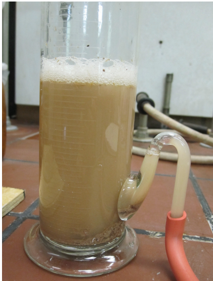
Abb. 229. Atterberg Zylinder, Untersuchung einer Putzprobe
