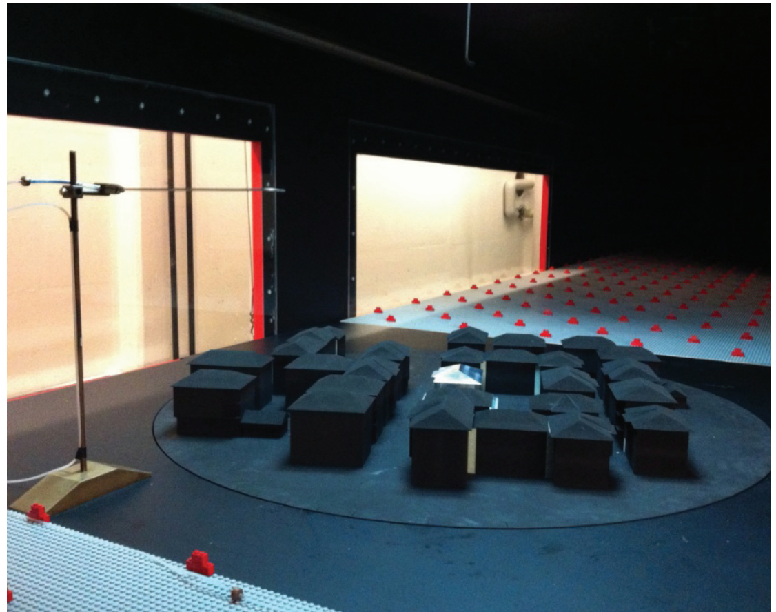
Abb. 065. Modelle auf der Drehscheibe im Windkanal und Anlaufstrecke (Foto: Thomas Giordano, 2012)
