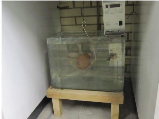
Abb. 227. Messung der scheinbaren Masse des in Wasser getauchten Probekörpers (Ziegel)
