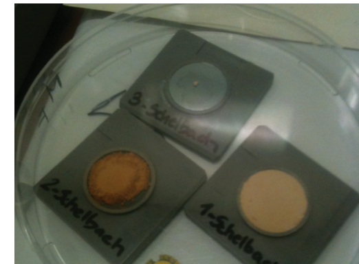
Abb. 228. Putzproben zur Untersuchung im Röntgendiffraktometer
