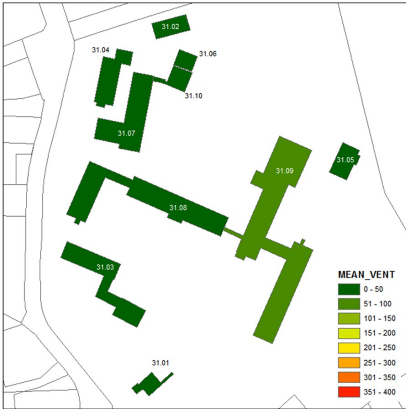
Bild 5-15: Gebäude der Liegenschaft ID 31 – Einfärbung nach Leistungsklasse der installierten Leistung aus Lüftungsanlagen in der Bedarfsklasse „Mittel“ ( P_{vent, mittel} )
