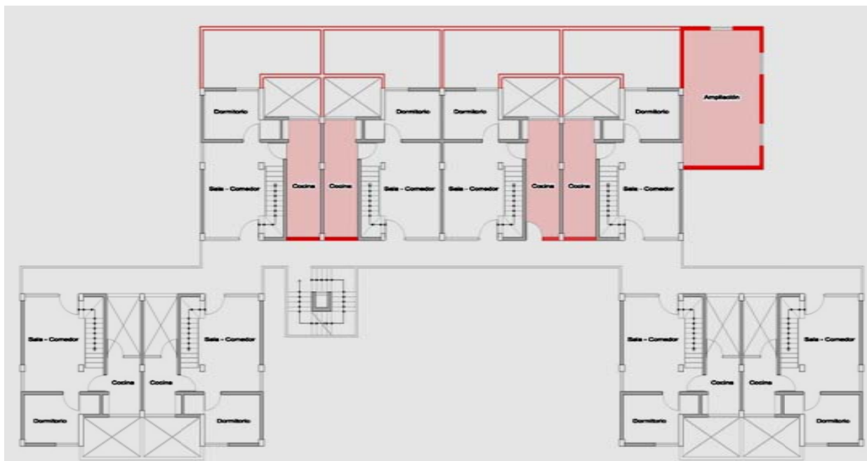
Veränderungen im 1.OG: Auffüllung des doppelt so hohen Waschrums und Anbau auf der entstandenen Bebauung an der Blockquerfassade
