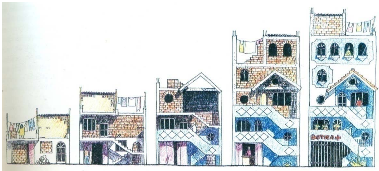
[11] Villa El Salvador, Muster des Verdichtungsprozesses einer informellen Hütte Quelle: Burga (2006)
