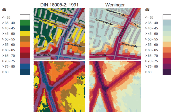
Abbildung 7.17: Das Farbschema der Entwicklungsstufe IV bei Anwendung in der Karte im Vergleich zum DIN-Schema. Mit dem neuen Farbschema können Bereiche hoher Belastung aufgrund der Helligkeit und Sättigung der verwendeten Farben sofort erkannt werden (Datenquelle: Anonymisierter Datensatz „Silent City“ der Lärmkontor GmbH).
