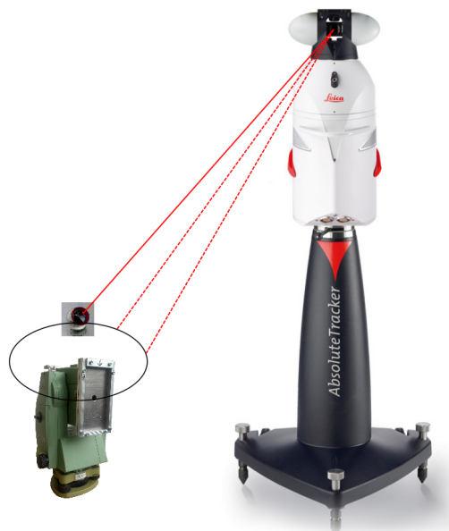
Abb. 3.8: Versuchsaufbau für die Kalibrierung der Drehgeschwindigkeiten des Leica TCRP 1105+ mit einem Lasertracker Leica AT901-MR [Sternberg u. a., 2012].
