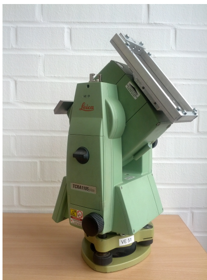
Abb. 3.7: Modifizierte Totalstation Leica TCRP 1105+ zur Kalibrierung von Gyroskopen im Smartphones [Sternberg u. a., 2012].
