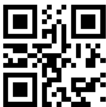
Abb. 6.5: QR-Code zur Initialisierung der Navigation. Anbringung beispielsweise an Namensschildern von Türen. Empfohlene Größe 20 \times 20 \text{ mm}^2 .
