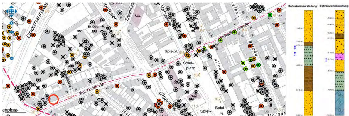
Abb 53 Ausschnitt Bohrkarte und Beispiel Bohrsäulen des Bohrdatenportals Hamburg
