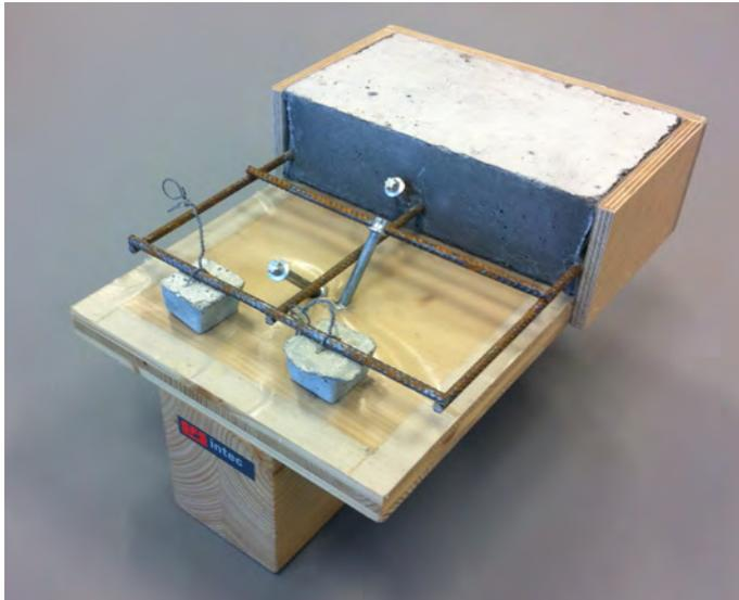
Abb 111 Modell Holz-Betonverbund
