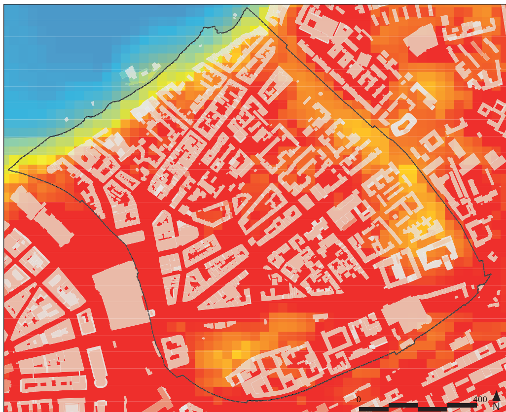
Abb. 4.3.1.1: Thermalbild von St. Georg. Bereiche in rot weisen um 11:17 Uhr eine Oberflächentemperatur von über 58 °C auf. Die Umgebung der Grünflächen und des Wassers weisen eine niedrigere Temperatur auf.
