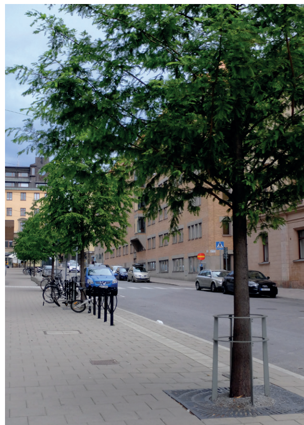
Abb. 3.2.2: Versickerung von Regenabflüssen in den Pflanzgruben von Straßenbäumen in Stockholm.
