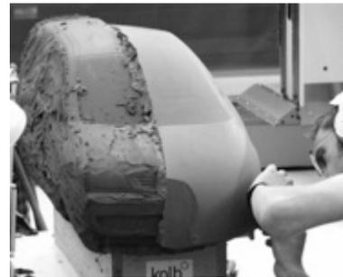
Abb. 32: 1:1-Modell DKW-Roller R 150 (Industriplastilin, 1957)
