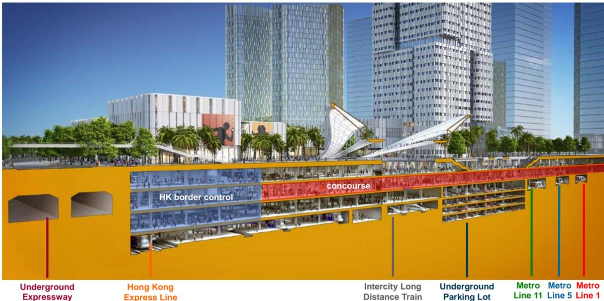
Abb. 4.2.4: Querschnitt der unterirdischen Verkehrsverbindungen am Qianhai Bay Integrated Transport Hub of Shenzhen Metro. Quelle: Lauer (2017: 156), bearbeitet nach Pomränke (2016: 23)
