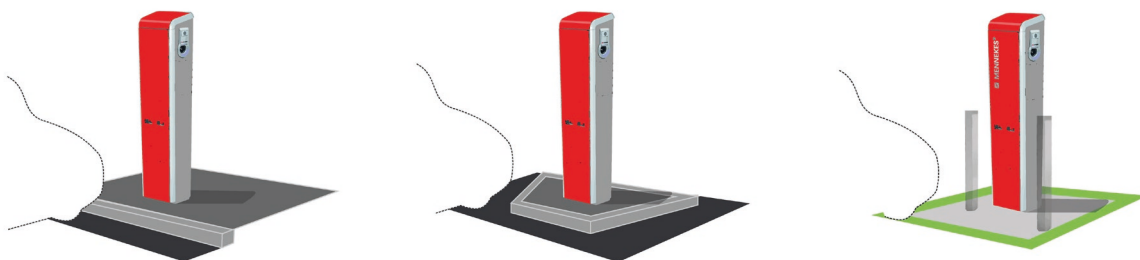
Abb. 61: Positionierung der Ladesäulen: auf dem Gehweg mit Hochbord, Nase, ebenerdig mit Anprallschutz (ARGUS o.J.)
