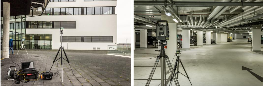
Abbildung 7.2: Messungen mit dem Velodyne VLP-16, Zoller+Fröhlich Imager 5010 und dem Trimble S7
