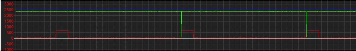
Abbildung 7.1: Messung der PPS-Signale (grün: iMAR iNAT-M200-FLAT; rot: uBlox-Chips; 1000 Punkte entsprechen 5 V)
