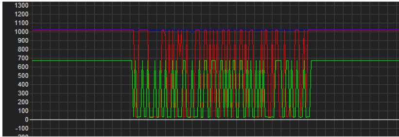
Abbildung 3.7: Messung des Signals am uBlox NEO-6M (grün: Ausgangssignal; rot: Signal nach Nutzung eines Pegelwandlers; 1000 Punkte entsprechen 5 V)
