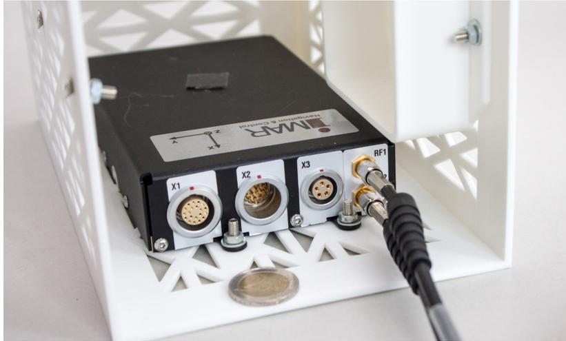
Abbildung 3.2: iMAR iNAT-M200-Flat im Prototypen des modularen Gehäuses, Leitungen führen zu den GNSS-Antennen (eigene Aufnahme)
