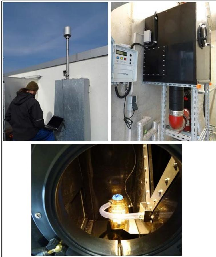
Abbildung 15: Niederschlagssensor mit Datenlogger (oben links), Messbox mit Datenlogger im EG (oben rechts), innerer Aufbau der Messbox mit V-Wehr und Kippzähler (unten).
