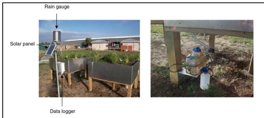
Abbildung 28: Beispielhafte Abbildung eines Gründach-test-plots in Adelaide, Australien (aus (Razzaghmanesh und Beecham 2014).
