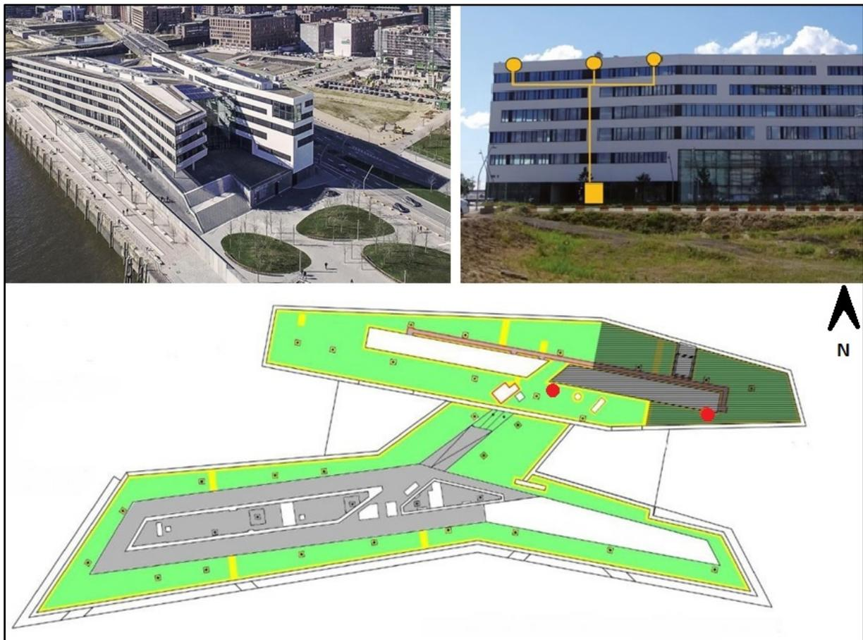
Abbildung 14: Luftansicht des HCU-Gebäudes mit Dachbegrünung (oben links, © HCU), schematische Skizze der Zusammenführung der Abflusstränge und zusammenführung in Messsystem im EG (oben rechts), Dachaufsicht HCU-Gebäude mit Standorten der Niederschlagsmesser (rote Punkte) und Einzugsgebiet zur Dachabflussmessung (schattiert) (© fairplants-system GmbH, T. Brinkmann, bearbeitet).
