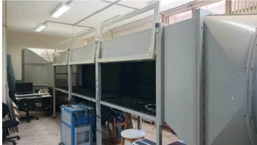
Figura 1. Vista del túnel de viento. A la izquierda, el cono donde el aire ingresa succionado por el ventilador de la derecha.
