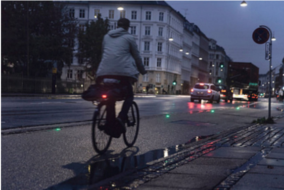
Abb. 35 LED-Signalisierung der Grünen Welle für Radfahrer
