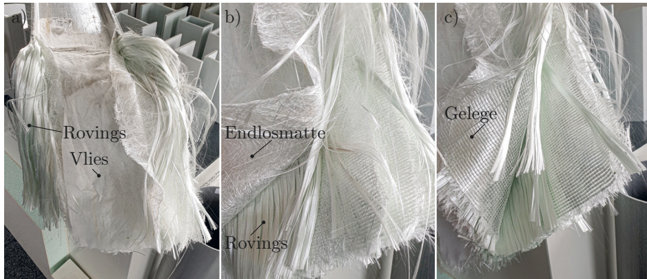
Bild 3-1: Anfang bzw. Ende eines Glasfaserhalbzeugs - a) Gesamtansicht, b) Vlies und Endlosmatte angehoben und c) zusätzlich UD-Fasern (Rowings) und unidirektionales Gelege angehoben
