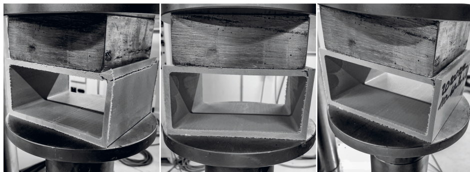
Bild 4-35: Tube-120: einseitiger Riss der Steg-Flansch-Verbindung in einer seitlichen Perspektive (a), Frontalansicht (b) und Perspektive von oben (c)
