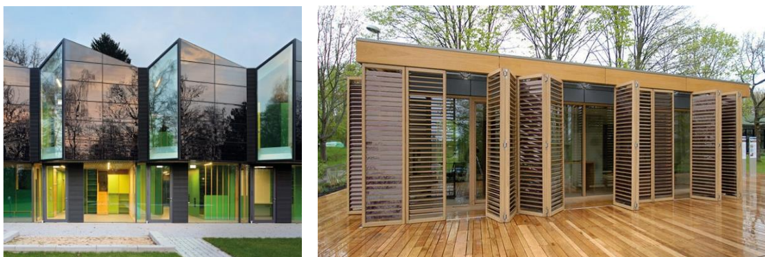
Abb. 108: Unauffällige PV-Integration durch Monochromie und gleiche Farbhelligkeit und -sättigung: +e Kita, Marburg (links: DBZ/Eibe Sönneken); rechts: Solar Decathlon Haus 2007, Team TU Darmstadt (TU Darmstadt/Leon Schmitt)
