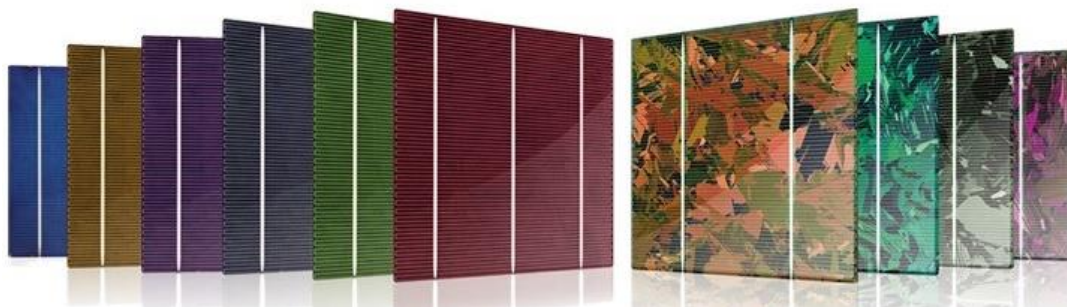
Abb. 76: Beispiele für Farbeffekte auf kristallinen Siliziumzellen, die durch unterschiedliche Dicken der Antireflexbeschichtung erzeugt werden (lofsolar)
