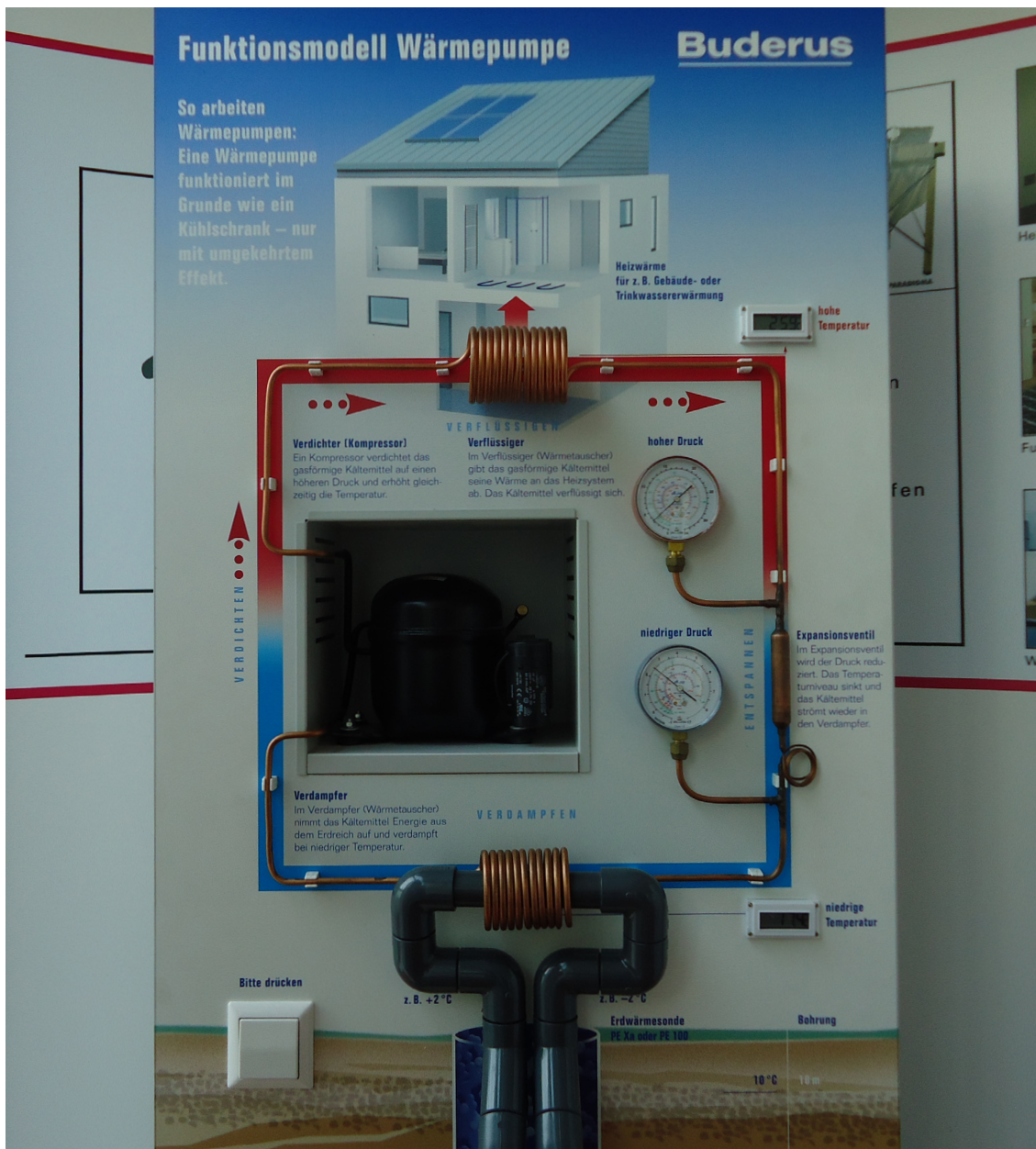
Abb. 3: Modell einer Wärmepumpe in der Ausstellung des Energie-BauZentrums Hamburg (Eigene Darstellung)
