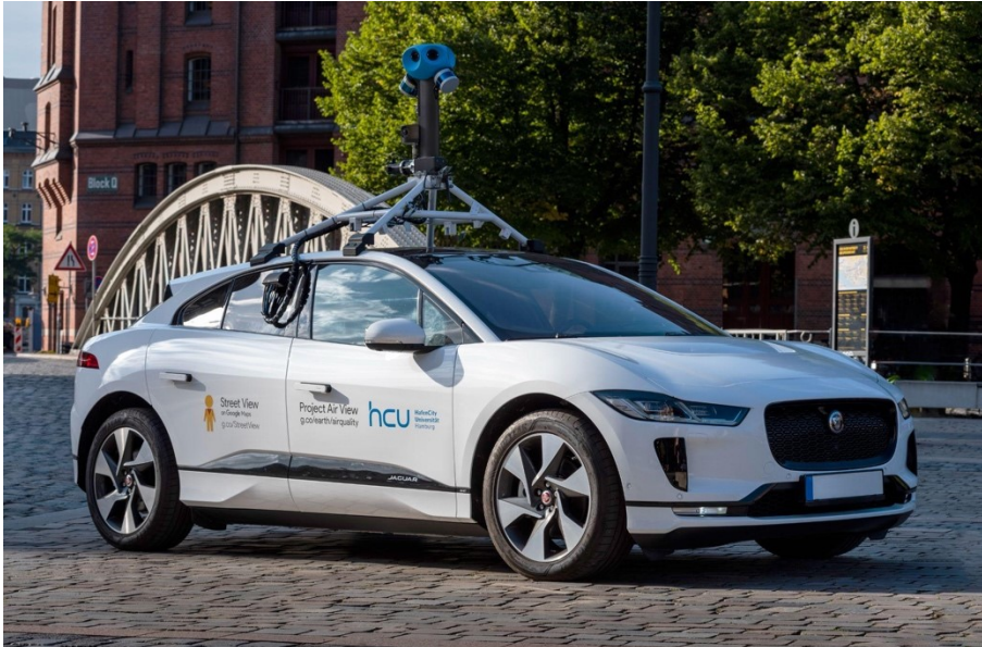
Abbildung 1: Project Air View Elektroauto in Hamburg mit Sensoren der Firma Aclima zur Messung von Luftschadstoffen und einer Kamera, um Bildmaterial für Google Maps zu erstellen, Foto: Google, 2021.
